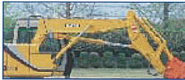
左側面集中配管
